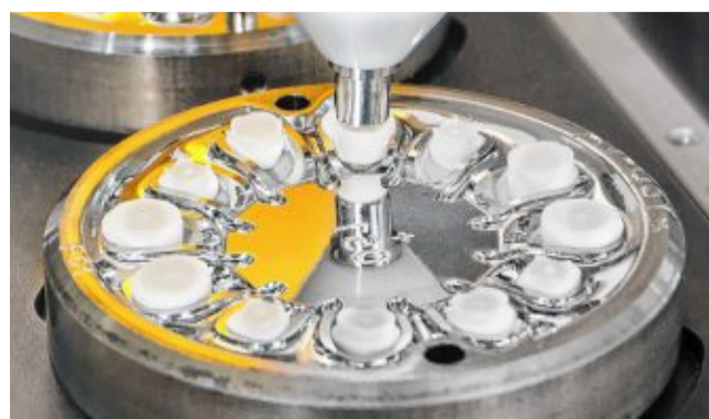
Robotergestützte Zahnprothesen-Fertigung bei Vita in Bad Säckingen am Hochrhein. BILD: VITA
