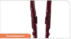
Die patentierte Guide-Stop™-Parallelführung wurde verändert. Hierdurch ist die Vorspannung der Feder verändert, sodass die Spitzen nicht mehr präzise zusammengeführt werden können und die Haptik sich ändert.
