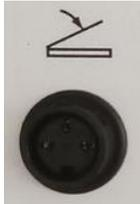
Der Fußschalter wird am Anschluss (25) auf der Geräterückseite angeschlossen.
