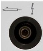
Zum monopolaren Schneiden und Koagulieren können ein Handgriff mit Fingerschalter oder ein Handgriff ohne Fingerschalter in Kombination mit einem Fußschalter angeschlossen werden. Handgriffe werden am Anschluss (10) angeschlossen. Die gewünschte Aktivelektrode ist in den Chirurgiehandgriff einzuschieben bis ein sicherer Halt gewährleistet ist.
