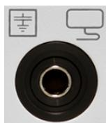
Die Neutralelektrode am Anschluss (14) anschließen. Es können wahlweise einteilige Neutralelektroden oder solche mit zwei Teilflächen, die eine Überwachung des Kontaktes zum Patienten ermöglichen, angeschlossen werden.
