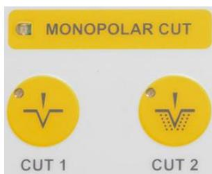
In dem auf der Frontplatte gelb gekennzeichneten Bedienfeld "Monopolar CUT" wird durch eine Leuchte (2) die Aktivierung von Schneidestrom angezeigt und es stehen zwei unterschiedliche Stromformen zum Schneiden zur Verfügung:
