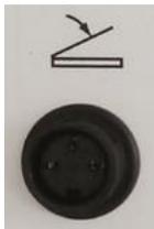
Die Aktivierung erfolgt ausschließlich über den Fußschalter, der an der Buchse (25) auf der Geräterückseite anzuschließen ist.
